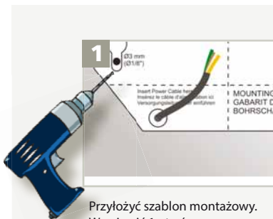
Montaż na ścianie nad drzwiami przesuwными lub obrotowymi
